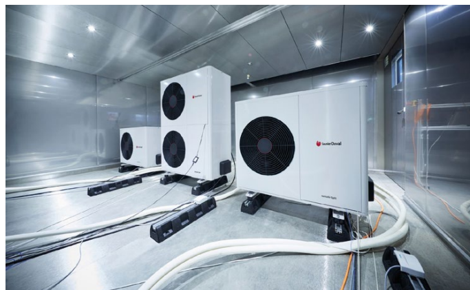
Komory klimatyczne symulują wszystkie potencjalne warunki eksploatacji
